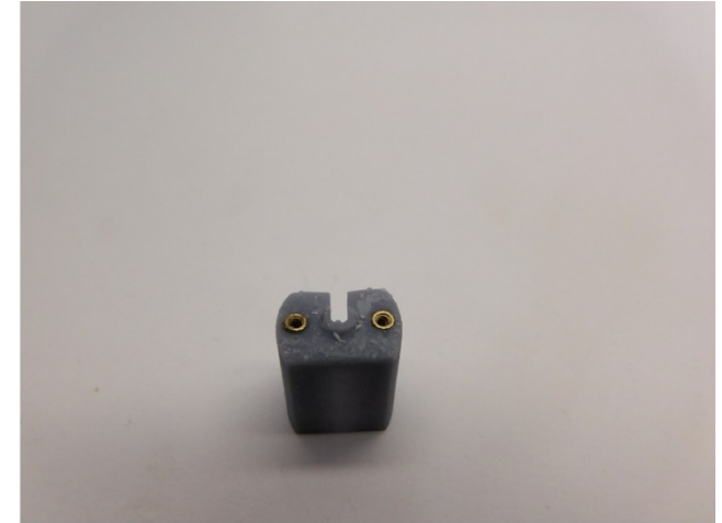
Die Messingeinsätze eingeklebt The brass inserts are glued De messing inserts zijn verlijmd
