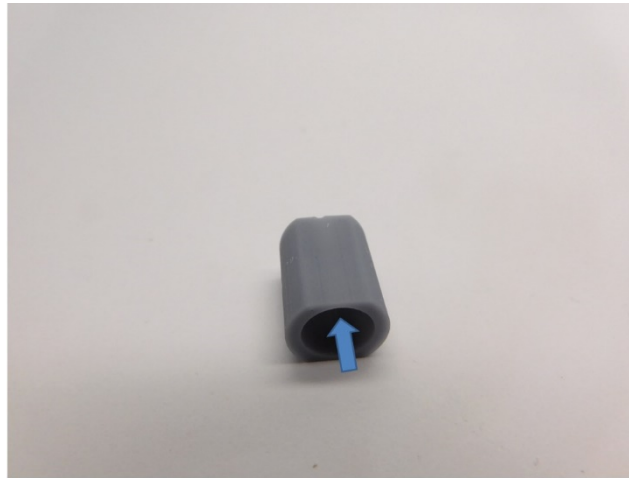
Machen Sie einen Schlitz in den Motorhalter Make a slot in the motor holder Maak een sleufje in de motor houder
