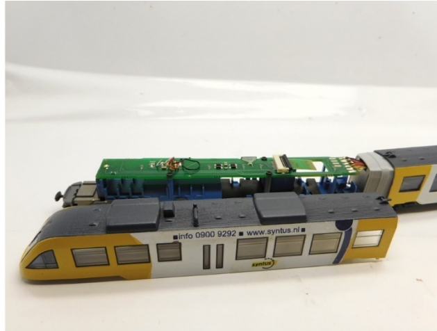
Gehäuse entfernen Remove housing Verwijder de kap
