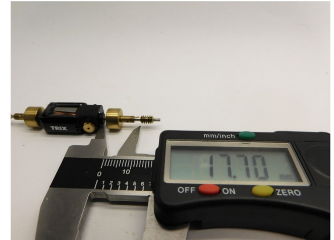
Maße prüfen Check dimensions Controleer de maatvoering
