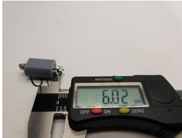
Maße prüfen Check dimensions Controleer de maatvoering
