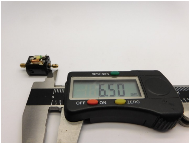
Maße prüfen Check dimensions Controleer de maatvoering
