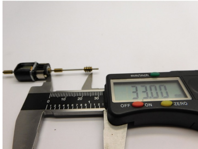
Maße prüfen Check dimensions Controleer de maatvoering
