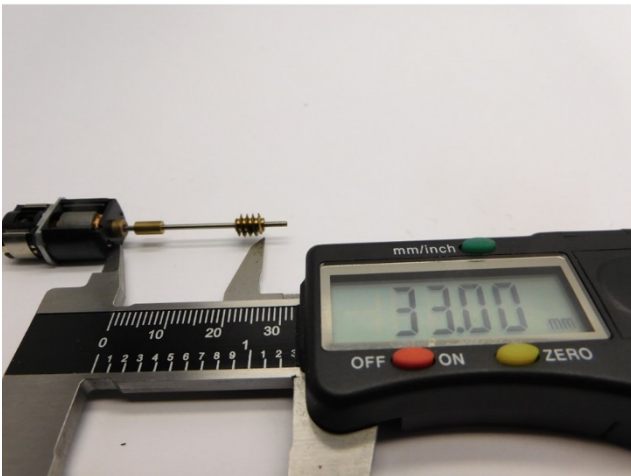
Maße prüfen Check dimensions Controleer de maatvoering
