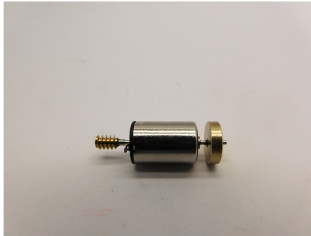
Die Metallteile sind verklebt The metal parts are glued De metaaldelen zijn verlijmd
