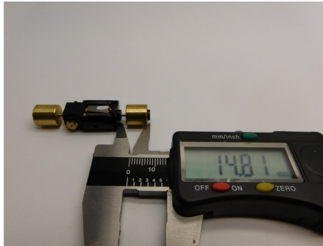
Maße prüfen Check dimensions Controleer de maatvoering
