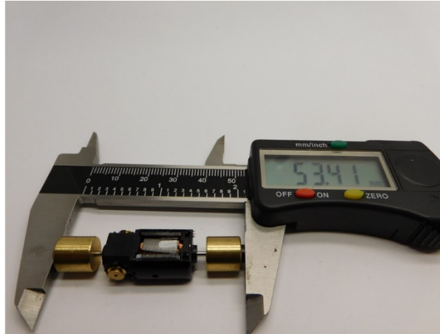
Maße prüfen Check dimensions Controleer de maatvoering
