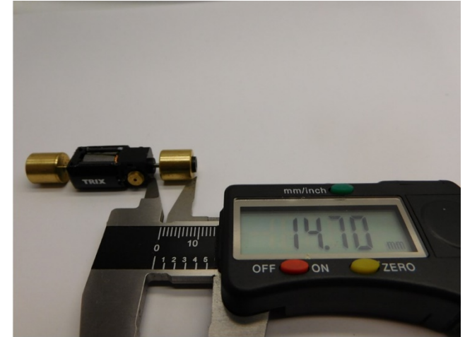
Maße prüfen Check dimensions Controleer de maatvoering
