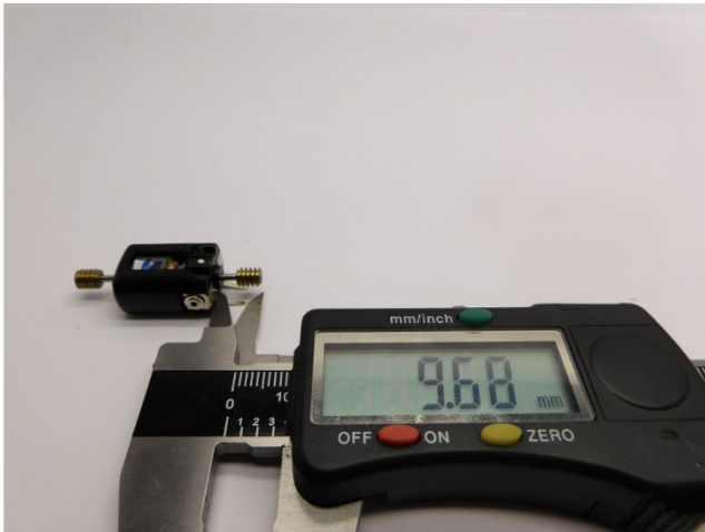
Maße prüfen Check dimensions Controleer de maatvoering
