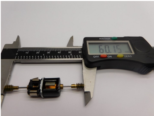
Maße prüfen Check dimensions Controleer de maatvoering
