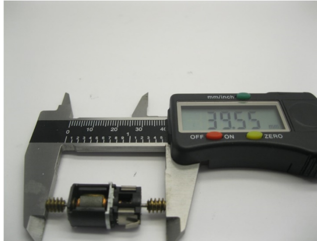
Maße prüfen Check dimensions Controleer de maatvoering
