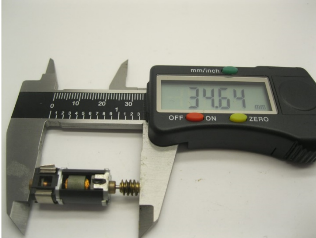
Maße prüfen Check dimensions Controleer de maatvoering
