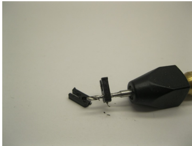
Loch auf 1.5 mm vergrößern Enlarge the hole to 1.5 mm Vergroot het gat naar 1.5 mm
