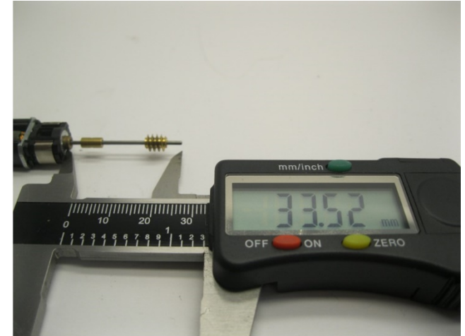
Maße prüfen Check dimensions Controleer de maatvoering
