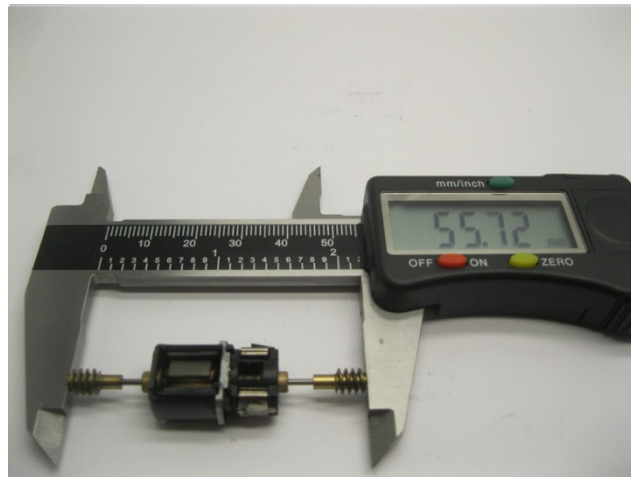
Maße prüfen Check dimensions Controleer de maatvoering
