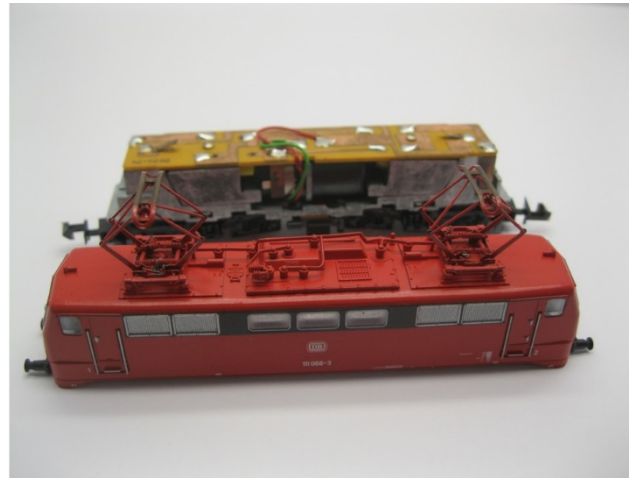
Gehäuse entfernen Remove housing Verwijder de kap
