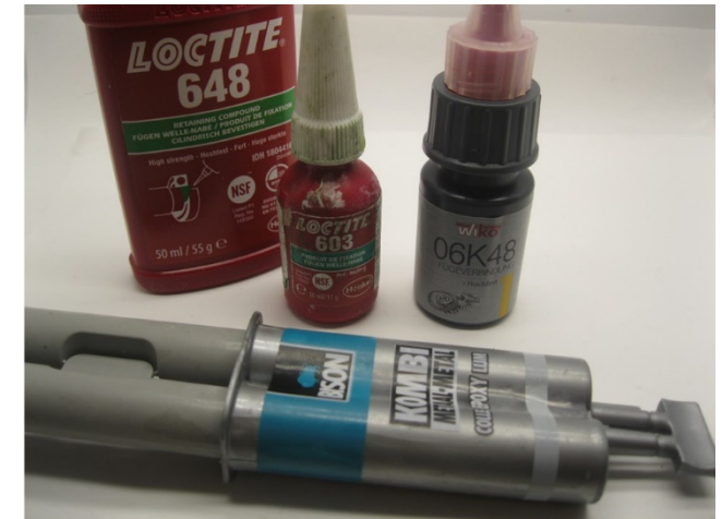
Metall Teile werden mit Loctite oder Metal Epoxy Kleber verklebt Metal parts are glued with Loctite or metal epoxy glue Metalen onderdelen worden gelijmd met loctite of epoxylijm voor metalen
