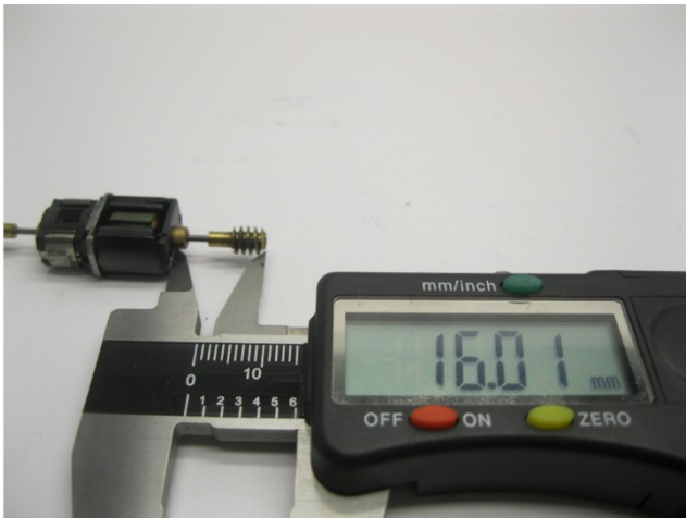
Maße prüfen Check dimensions Controleer de maatvoering
