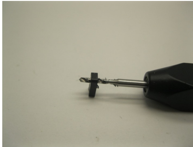
Loch auf 1.5 mm vergrößern Enlarge the hole to 1.5 mm Vergroot het gat naar 1.5 mm
