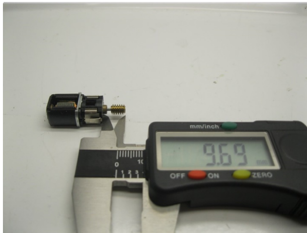
Maße prüfen Check dimensions Controleer de maatvoering
