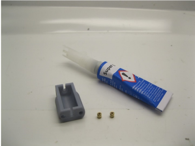
Die Messingeinsätze werden mit Sekundenkleber in den Motorhalter eingeklebt The brass inserts are glued into the motor holder with superglue De messing inserts worden met secondelijm verlijmd in de motor houder
