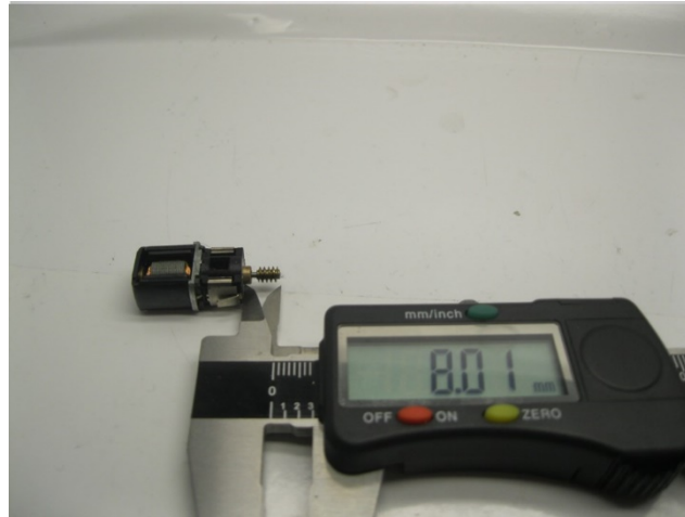
Maße prüfen Check dimensions Controleer de maatvoering
