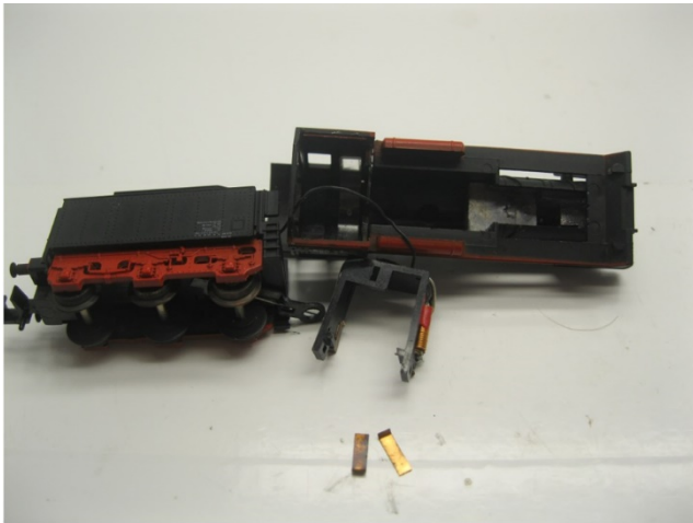
Alter Motorkontakt entfernen Remove old motor contacts Verwijder de oude motorcontacten
