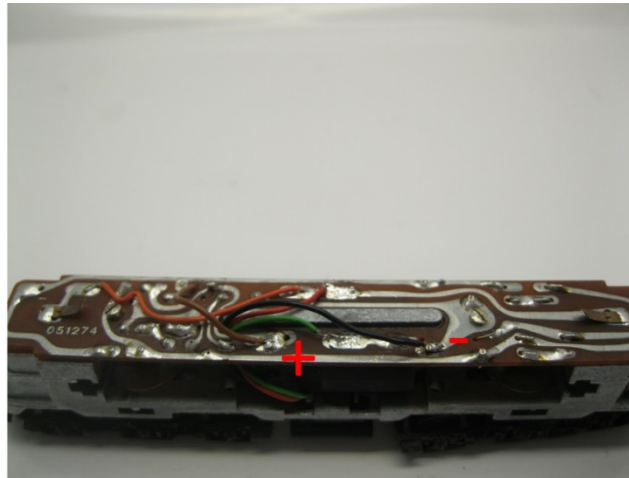
Löten Sie die Drähte Solder the wires Soldeer de draden
