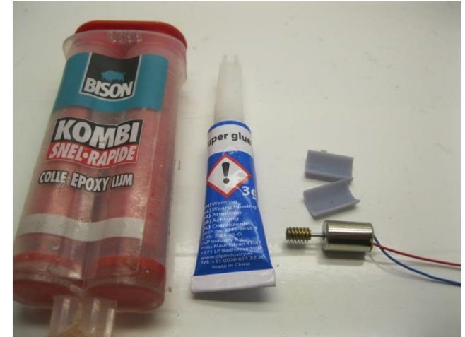
Der Motor wird mit Epoxidkleber oder Sekundenkleber zwischen den Motorhalter Teile eingeklebt The motor is glued between the motor holder parts with epoxy glue or super glue De motor wordt verlijmd tussen de motorhouder delen met secundelijm of epoxy lijm
