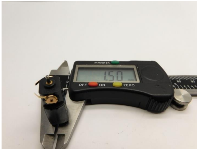
Wellenmaß prüfen. Modelle vor 1990 haben manchmal 1 mm Achsen, dann NICHT die Wellenadapter verwenden! Check the size of the axle. Models before 1990 sometimes have 1 mm axles then DO NOT use the axle adapters! Controleer de asmaat. Modellen van voor 1990 hebben 1 mm assen, gebruik dan de as adapters NIET!
