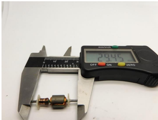
Maße prüfen Check dimensions Controleer de maatvoering
