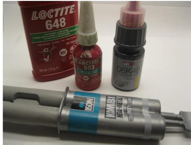
Metall Teile werden mit Loctite oder Metal Epoxy Kleber verklebt Metal parts are glued with Loctite or metal epoxy glue Metalen onderdelen worden gelijmd met metaallijm of epoxylijm voor metalen
