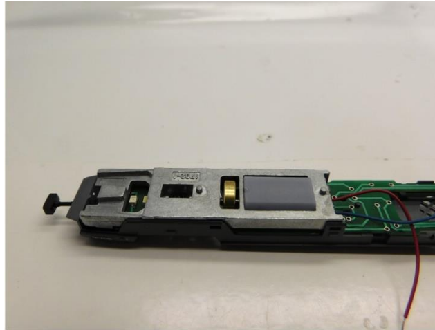
Motor und Gewicht platzieren Mount the motor and the weight Plaats de motor en het gewicht
