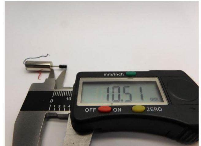
Maße prüfen Check dimensions Controleer de maatvoering
