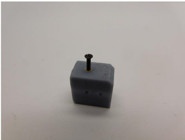
Die Messingeinsatz ist eingeklebt The brass insert is glued De messing insert is verlijmd
