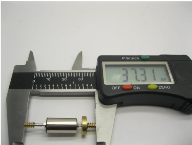
Maße prüfen Check dimensions Controleer de maatvoering
