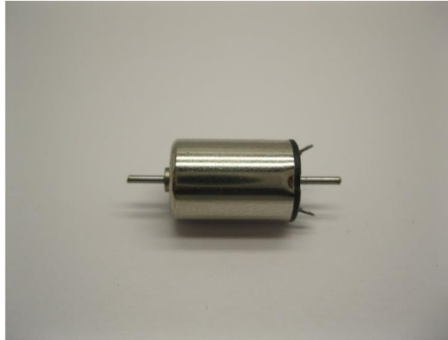
Die Kontakte biegen Bend the contacts Buig de contacten
