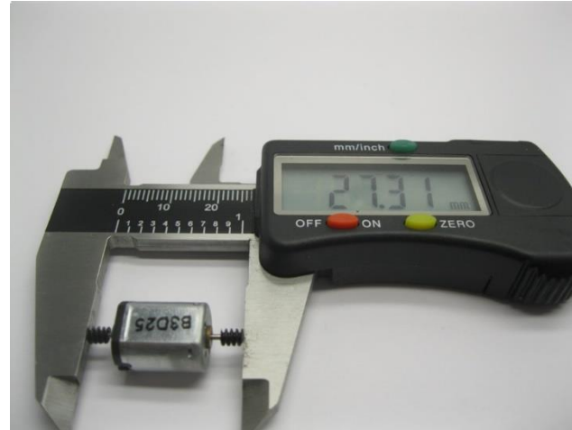
Maße prüfen Check dimensions Controleer de maatvoering
