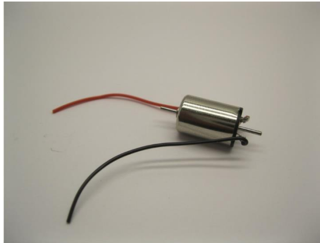
Die Drähte sind verlötet The wires are soldered De draden zijn gesoldeerd
