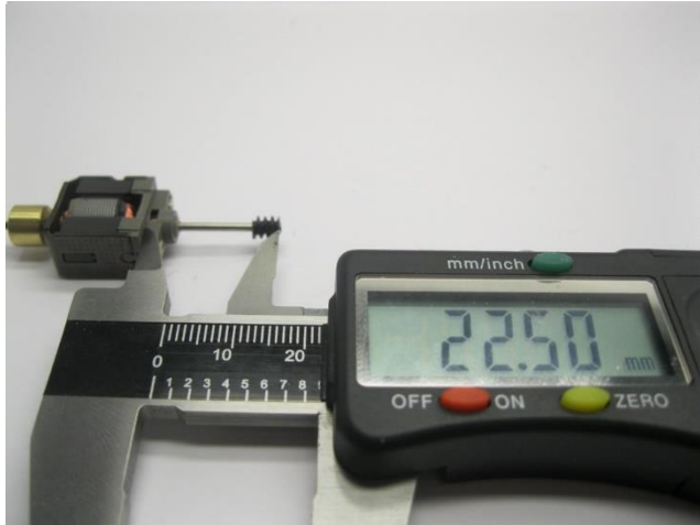
Maße prüfen Check dimensions Controleer de maatvoering
