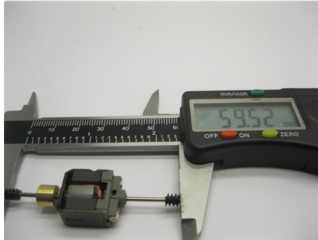
Maße prüfen Check dimensions Controleer de maatvoering
