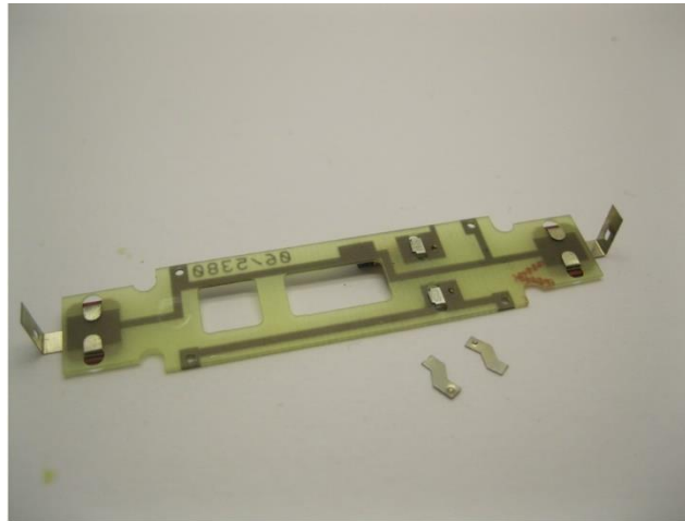
Alter Motorkontakte entfernen Remove old motor contacts Verwijder de oude motorcontacten
