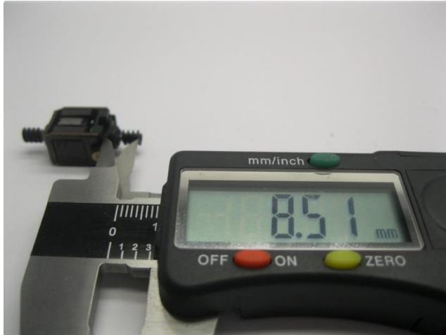
Maße prüfen Check dimensions Controleer de maatvoering
