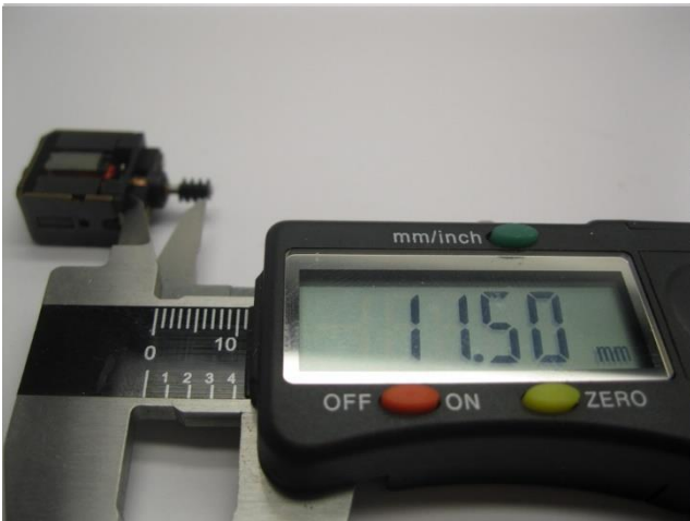
Maße prüfen Check dimensions Controleer de maatvoering
