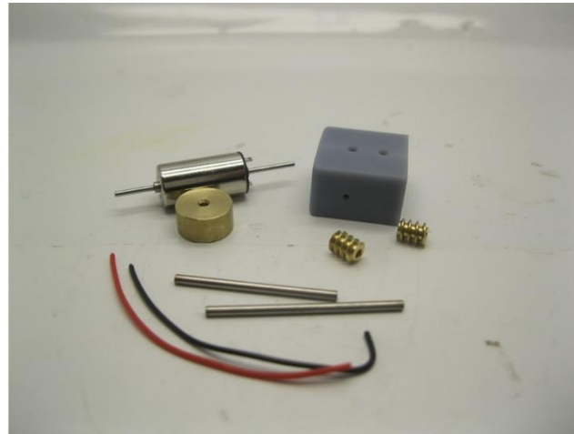
Die Teile des Bausatz The parts of the kit Onderdelen van de ombouwsset
