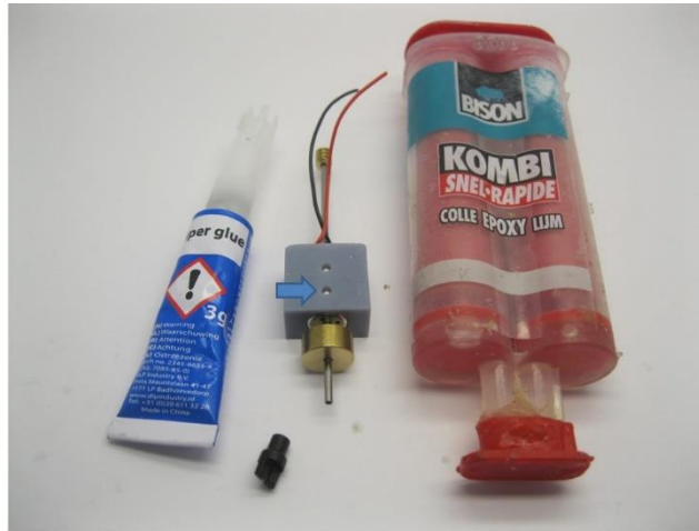
Der Motor und Kardanschale werden mit Epoxidkleber oder Sekundenkleber geklebt The motor and the cardan bearing are glued with epoxy glue or super Glue De motor en de kardankoppeling worden met epoxylijm of secondelijm verlijmd
