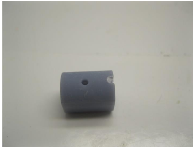
Wir machen einen Schlitz im Halter We make a slot in the holder Maak een sleuf in de houder
