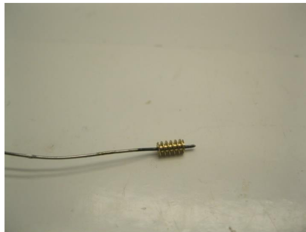
Tragen Sie Klebstoff auf die Innenseite des Teil Apply glue on the inside of the part Plaats alleen lijm aan de binnenzijde van de onderdelen
