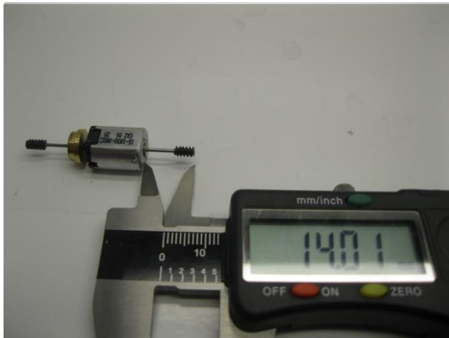
Maße prüfen Check dimensions Controleer de maatvoering
