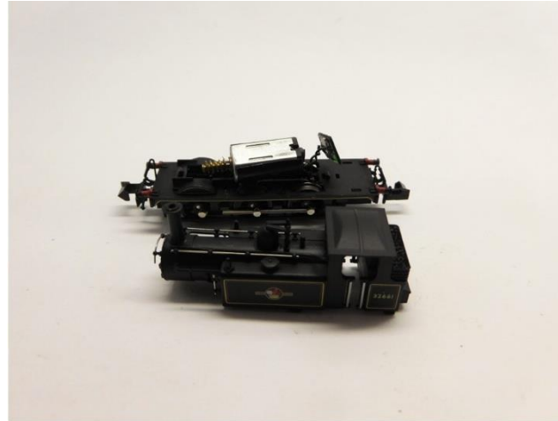
Gehäuse entfernen Remove housing Verwijder de kap
