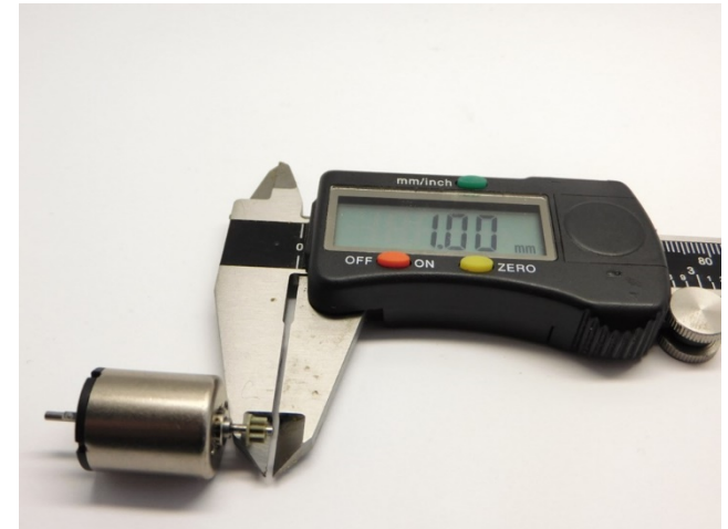
Maße prüfen Check dimensions Controleer de maatvoering
