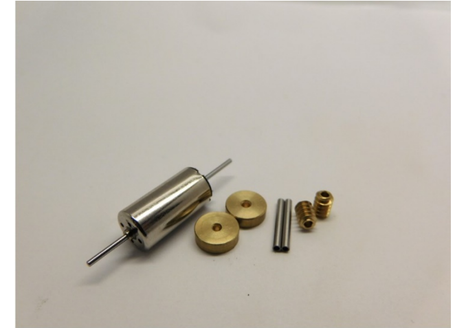
Metallteile werden mit Loctite oder Metal Kleber verklebt Metal parts are glued with Loctite or metal glue Metalen onderdelen worden gelijmd met metaallijm of epoxylijm voor metalen
