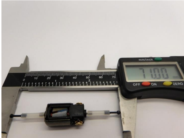
Maße prüfen Check dimensions Controleer de maatvoering
