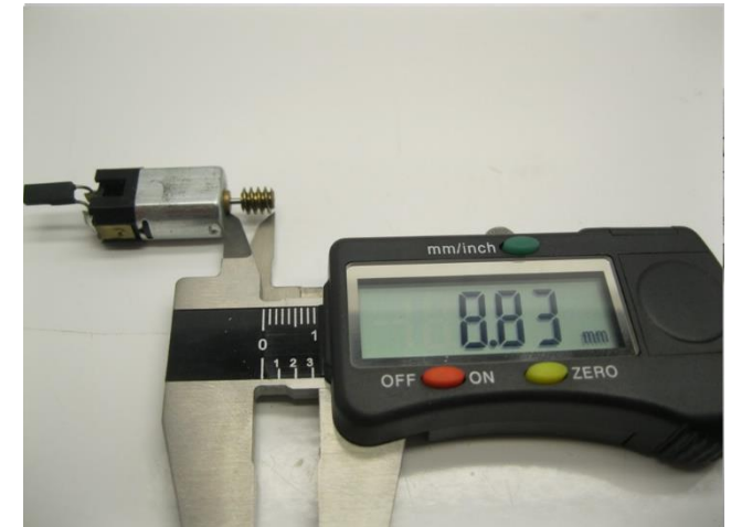
Maße prüfen Check dimensions Controleer de maatvoering
