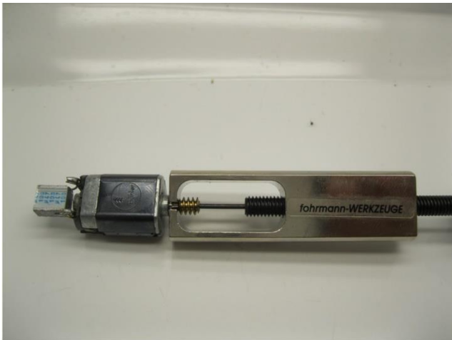
Entfernen Sie die Schnecken vom alten Motoren Remove the worms from the old motors Verwijder de oude wormwielen van de motoren
