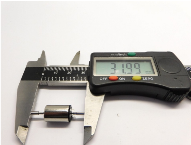
Maße prüfen Check dimensions Controleer de maatvoering
