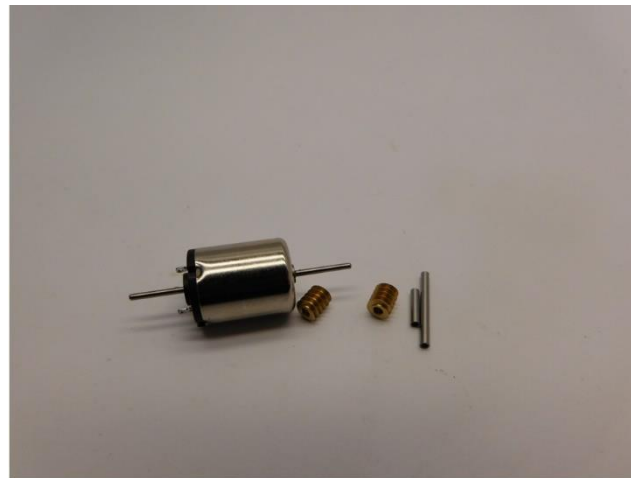
Die Metallteile werden mit Loctite oder Metall Epoxy kleber verklebt The metal parts are glued with loctite or metal epoxy glue Metalen onderdelen worden gelijmd met Loctite of epoxylijm voor metalen
