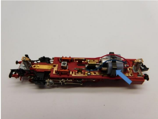
Platzieren die Klemme Mount the motor clamp Plaats de motorklem
