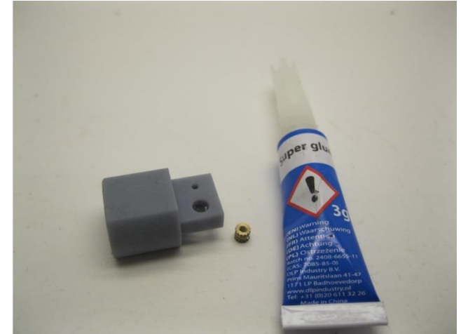
Die Messingeinsatz wird mit Sekundenkleber in den Motorhalter eingeklebt The brass insert is glued into the motor holder with superglue De messing insert wordt in de motorhouder verlijmd met secondelijm
