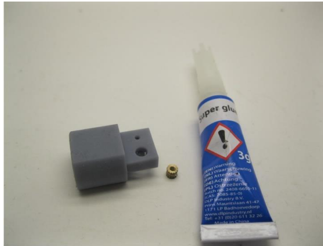
Die Messinginsert und Lager werden mit Sekundenkleber in den Motorhalter eingeklebt The brass insert and bearing are glued into the motor holder with superglue De messing insert en het lager worden in de motorhouder verlijmd met secundelijm
