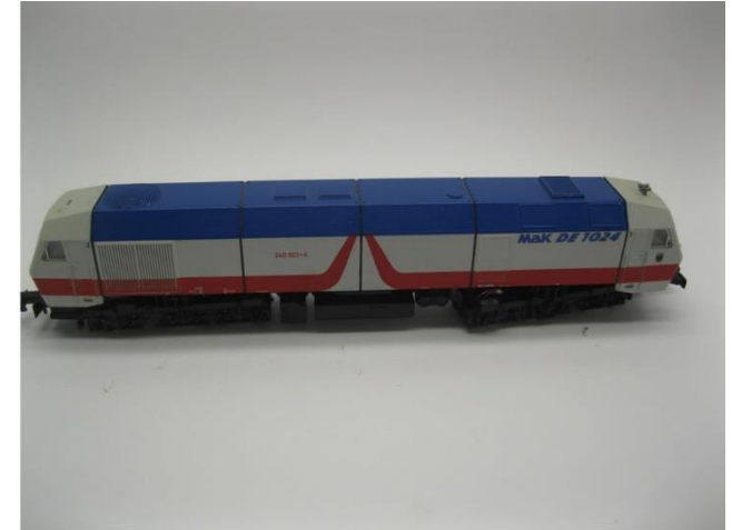
Gehäuse platzieren Mount body Plaats de kap
